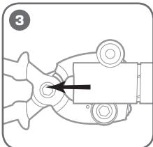
**Используя нож для продольного реза и призматический ролик, разрежте изоляцию вдоль кабеля.**
