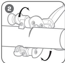
**Захватите кабель и, совершая круговые движения вокруг кабеля, разрежьте изоляцию в поперечном направлении.**
