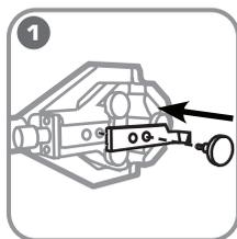
**Установите нож для снятия полупроводящего экрана.**
