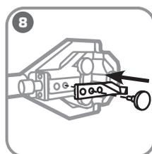
**Установите нож для снятия изоляции.**
