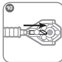
**Вращая регулировочный винт, настройте нож на необходимую глубину срезаемого слоя.**
