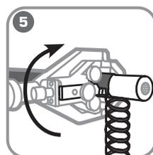
**Вращая инструмент за рукоятку вокруг кабеля по спирали снимите полупроводящий экран.**
