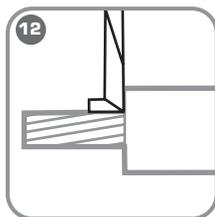
**В конце движения сделайте оборот перпендикулярно оси кабеля для формирования равномерного среза.**
