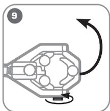
**Поверните винт фиксации откидной планки. Откройте планку, установите кабель в инструмент, закройте планку и зафиксируйте винтом.**
