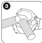
**Создайте давление помпой, разрежьте кабель. Сбросьте давление до полного возврата лезвий**
