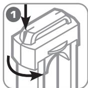
**Отжав фиксатор, поверните крышку рабочей головки, снимите ее**
