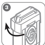
**Установите крышку на место, поверните ее до срабатывания фиксатора**
