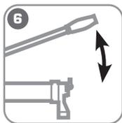
**Создайте помпой давление в гидроцилиндре. Опресуйте изделие**
