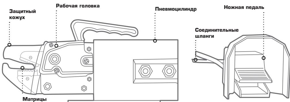
Пресс-клещи пневматические состоят из пневмоцилиндра выполненного в одном корпусе с рабочей головкой, закрывающейся пластиковым кожухом в процессе работы, ножной педали для управления подачей воздуха, позволяющей варьировать скоростью опрессовки, и комплекта соединительных шлангов.
