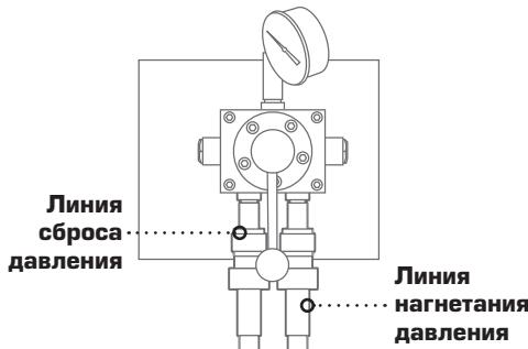
5. Подсоедините при помощи бысторазъемных соединений рукава высокого давления соответственно к линиям подачи давления и сброса нагрузки;
