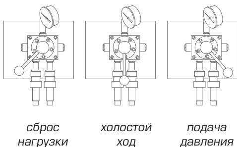
Крутящий момент от привода через соединительную муфту передается на двухступенчатый насос. Двухступенчатый насос обеспечивает повышенный расход рабочей жидкости на первой ступени с низким давлением до 90 кгс/см<sup>2</sup>, что ускоряет преодоление свободного хода штока исполнительного механизма, и тем самым, уменьшает общее время выполнения операции. На второй ступени работы насоса создается необходимое рабочее давление — 750 кгс/см<sup>2</sup>.
