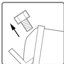
Поверните дроссельный винт помпы в положение «Открыть». Откройте сливную пробку.
