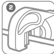
**Установите разрезаемое изделие в рабочую зону болтореза**
