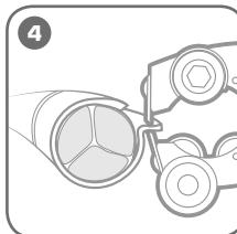
**Зажмите край изоляции ножами для захвата и снимите ее с кабеля.**
