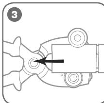
**Используя нож для продольного реза и призматический ролик, разрежьте изоляцию вдоль кабеля.**
