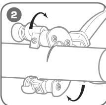
**Захватите кабель и, совершая круговые движения вокруг кабеля, разрежьте изоляцию в поперечном направлении.**
