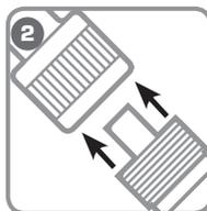
**2** Присоедините рукав высокого давления (РВД) помпы к клапану гидравлического инструмента
