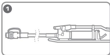
**1** Установите помпу и ножницы по возможности на ровной, плоской поверхности. Такое положение обеспечит устойчивость во время работы
