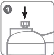
**Установите помпу под углом 30° заливной пробкой вверх и открутите заливную пробку на 2-3 оборота. Пробка должна остаться в резьбовой части, чтобы масло не разбрызгивалось. Для стравливания воздуха, произведите установку педали в рабочее положение.**
