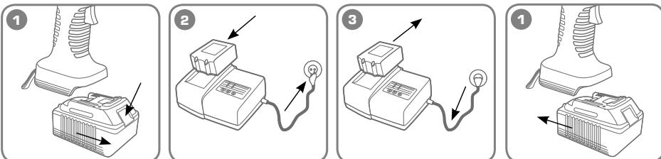
Для снятия аккумулятора, нажмите на фиксатор и выньте его из корпуса инструмента.
