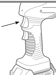
**Нажмите на кнопку «ПУСК» и держите нажатой ее до срабатывания механизма автоматического сброса давления. При этом раздается характерный щелчок.**
