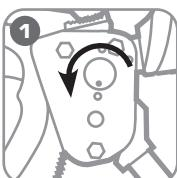
Разблокируйте рукоятки, повернув фиксатор разблокировки.
