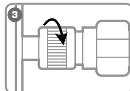
**Плотно затяните гайку БРС, приложив достаточное усилие для обеспечения хорошего соединения (без применения слесарного инструмента)**
