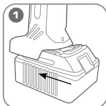
**Вставьте аккумулятор в корпус инструмента до щелчка, при этом прозвучит характерный сигнал и сработает световая индикация**
