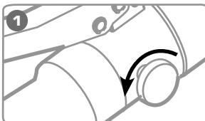
**Поверните винт сброса давления в положение «Открыть».**
