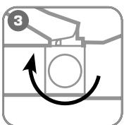
**Поверните винт сброса давления в положение «Закрыть»**
