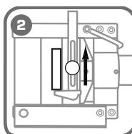
**Отрегулируйте установочную скобой шину по центру матрицы.**
