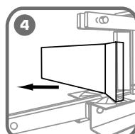
**Сбросьте давление на помпе. Откройте пружину. Извлеките шину из рабочей зоны.**
