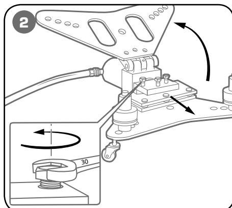
**Откройте верхнюю плиту. Снимите прижимную пластину оправки для установки профиля, ослабив установочные болты, используя ключ на «30».**
