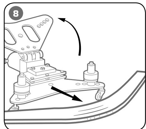
Работая помпой, согните шину под нужным углом. Контролируйте угол по шкале для гибки на ребро. По окончанию,бросьте давление. Откройте верхнюю плиту. Извлеките готовую шину
