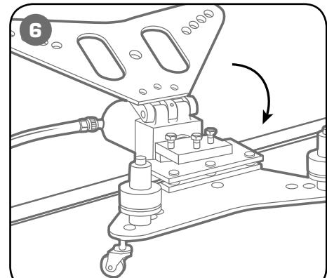
Следите, чтобы концы упорных валиков попали в соответствующие отверстия. Закройте верхнюю плиту.
