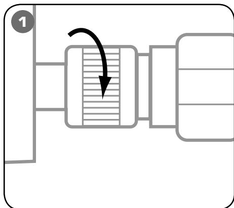
**Подсоедините рукав помпы к быстро-разъемному соединению. Плотно затяните гайку.**
