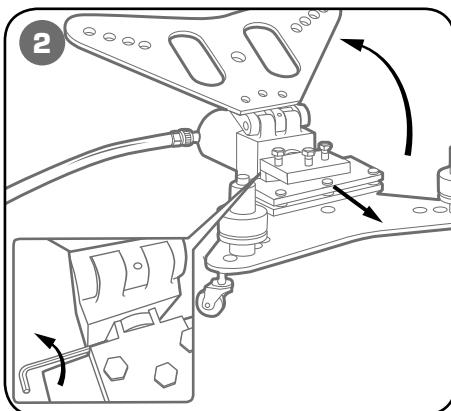
**Откройте верхнюю плиту. Снимите оправку для установки профилей для гибки на ребро и снимите упорные валики.**
