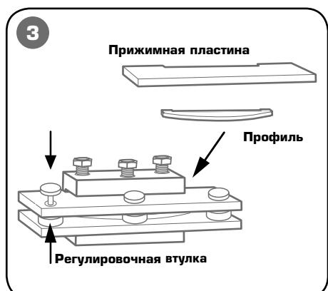
**Установите в оправку профиль нужного типоразмера длягибы на ребро, а также регулировочные втулки в зависимости от толщины шины. Поверх установите прижимную пластину.**
