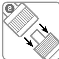
1. После завершения работы убедитесь, что давление в системеброшено. Открутите гайкубыстроразъемного соединения.
