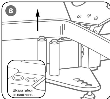
Работая помпой, согните шину под нужным углом. Контролируйте угол по шкале для гибки на плоскость. По окончанию сбросьте давление. Откройте верхнюю плиту и извлеките готовую шину.
