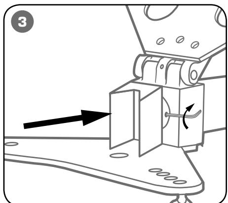
**Установите V-образную матрицу для гибки на плоскость на шток. Задекуруйте ее установочными винтами.**
