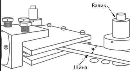
Установите обрабатываемую шину в оправку. Ориентируясь по шкале для гибки на ребро, установите упорные валики в отверстия, соответствующие ширине шины (Размер В).
