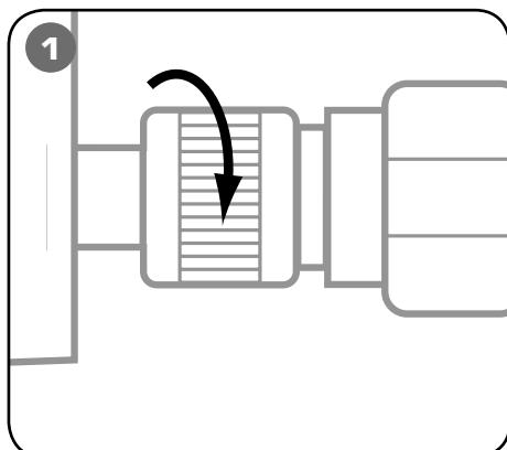
**Подсоедините рукав помпы к быстро-разъемному соединению. Плотно затяните гайку [от руки].**
