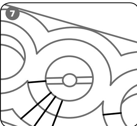
Поверните упорные валики так, чтобы метки на них были в положение «О» на угловой шкале для гибки на ребро.
