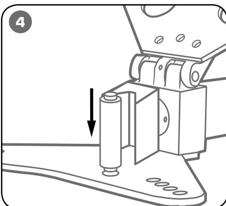
**Установите шпильку необходимого диаметра, в центральное отверстие плиты.**
