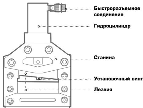
При сбросе давления возвратная пружина разжимается и возвращает поршень в исходное положение
