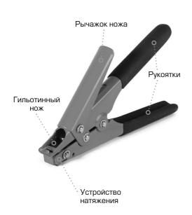
Инструмент для монтажа стальных стяжек TG-O3 состоит из прорезиненных рукояток, устройства натяжения с подпружиненной зубчатой собачкой и гильотинного ножа для разрезания стяжки
