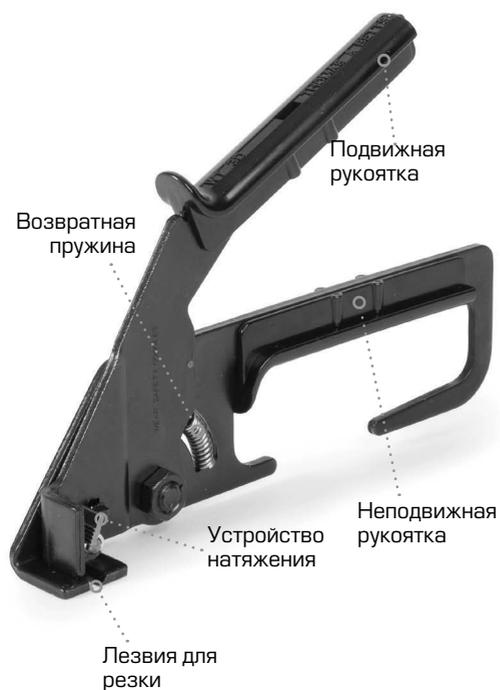
Инструмент для монтажа нейлоновых стяжек TG-04 состоит из подвижной и неподвижной рукояток, устройства натяжения с подпружиненной зубчатой собачкой и лезвиями для отрезания стяжки
