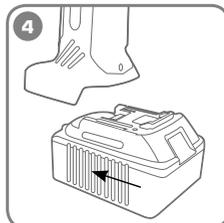
**Вставьте аккумулятор обратно в корпус инструмента до щелчка.**
