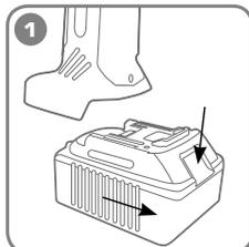
**Для снятия аккумулятора, нажмите на фиксатор и выньте его из корпуса инструмента.**
