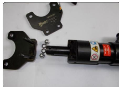
5. Поверните ножницы штоком на себя. Возьмите шестигранник и выкрутите из торцевых отверстий, расположенных с двух сторон, стопорные винтовые штифты.
