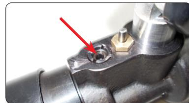
2. Возьмите шестигранник и поверните регулировочный винт по часовой стрелке для увеличения величины давления на матрицы. Увеличивать давление следует аккуратно, т.к. поворот винта даже на 90° увеличивает усилие ориентировочно на 10 Мпа. Поэтому увеличивать давление надо постепенно, поворачивая винт каждый раз не более чем на 30°. Поворот винта против часовой стрелки, наоборот, будет ослаблять создаваемое давление.
