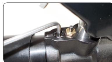
3. После регулировки клапана АСД опробуйте пресс на холостом ходу с установленными в него матрицами. Ориентировочно, АСД должен срабатывать на 9–10 качке после смыкания матриц. Если АСД не срабатывает, либо срабатывает раньше чем положено, то необходимо снова отрегулировать клапан, до тех пор, пока не получите желаемый результат.
