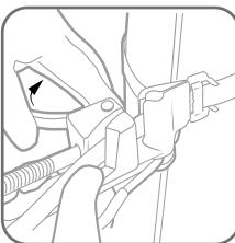
Отведите прижимной рычаг и установите инструмент до упора в бугель так, чтобы лента прошла через направляющие пазы. Затем отпустите прижимной нож для фиксации ленты в инструменте.
