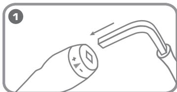
Вставить ключ для настройки усилия крутящего момента в рукоятку динамометрической отвертки
