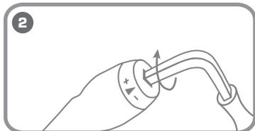
Повернуть ключ по часовой стрелке, для установки момента затяжки, ориентируясь на цифровую шкалу
