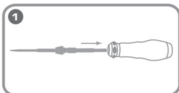
Установите выбранную рабочую часть в рукоятку динамометрической отвертки, до щелчка.
