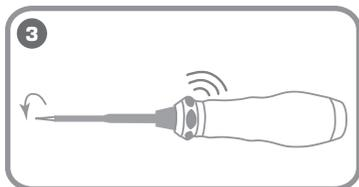
В процессе завинчивания, при достижении установленного крутящего момента, раздастся щелчок.
