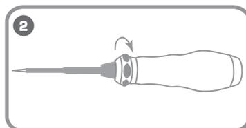
Чтобы поменять рабочую часть, необходимо повернуть замок по часовой стрелке, как показано на маркировке рукоятки "OPEN"
