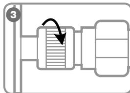
**Плотно затяните гильзу БРС, приложив достаточное усилие (без применения слесарного инструмента)**
