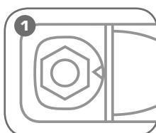
**Установите гайку в рабочую область гайкомола**
