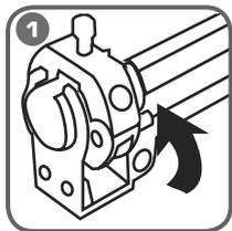
**Положить инструмент на ровную поверхность. Выбрать необходимый зажим СОАС . Повернуть зажим вращающийся так чтобы штифт расположился между зазором стойки.**
