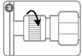
**Плотно затяните гайку БРС, приложив достаточное усилие (от руки) для обеспечения хорошего соединения (без применения слесарного инструмента)**
