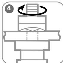
**4** Вставьте шпильку в направляющее отверстие в листе, установите пуансон по резьбе до упора. Лист расположите между матрицей и пуансоном без зазора
