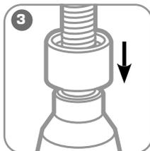
**3** Поверх опорной втулки установите выбранную матрицу из вышеперечисленного ряда
