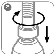
**2** Закрутите шпильку диаметром 20 мм в шток поршня. На шпильку установите опорную втулку
