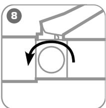
**8** Поверните винт сброса давления в положение «Открыть»
