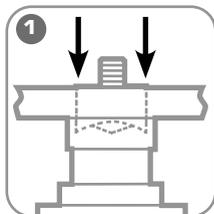
**1** Пробейте отверстие диаметром 20,5 мм любым удобным способом
