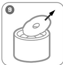
**9** Демонтируйте пуансон и матрицу. Удалите из матрицы отходы пробиваемого материала
