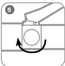
**5** Поверните винт сброса давления в положение «Закреть»
