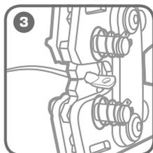
Установите изделие в рабочую зону и опрессуйте его, прикладывая усилие к рукояткам. В конечном положении выдержите рукоятки сомкнутыми 2-3 секунды для формирования опрессовки.
