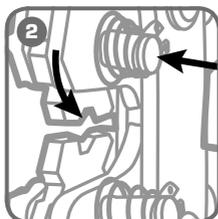
Нажмите на ось и установите нужное сечение, вращая матрицу. Отпустите ось, чтобы матрица зафиксировалась в рабочем положении упорной планкой. Повторите операцию для второй матрицы.
