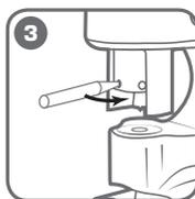
Зафиксируйте пуансон гайкой, используя вороток (ШД-95). Гайка ШД-110 затягивается от руки
