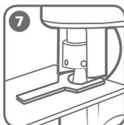
Установите съемник между опорой и шиной. Аккуратно снимите шину с пуансона.
