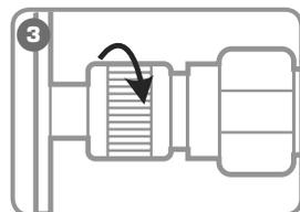
**Плотно затяните гайку БРС, приложив достаточное усилие (от руки) для обеспечения хорошего соединения**
