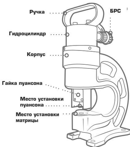
При падении давления возвратная пружина разжимается и перемещает поршень в исходное положение
