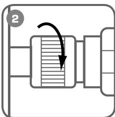
Подключите внешний гидравлический насос (помпу) при помощи рукава высокого давления через быстроразъемное соединение. Плотно затяните гайку
