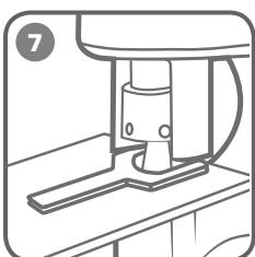
Установите съёмник и сбросьте давление в системе повернув винт сброса давления против часовой стрелки на 3/4 оборота в положение «Открыто»
