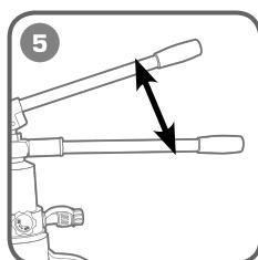
Работайте рукоятками до полной пробивки отверстия в шине
