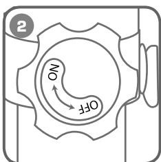
Подготовьте контур быстрого хода поршня, для чего поверните винт быстрого хода в положение «ON»
