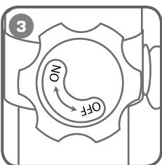
Отключите контур быстрого хода поршня, для чего поверните винт быстрого хода в положение «OFF».
