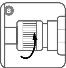
После завершения работы убедитесь, что давление в системе помпы сброшено. Открутите гайку быстроразъемного соединения и отсоедините рукав высокого давления
