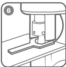
Установите съёмник и сбросьте давление в системе при помощи помпы
