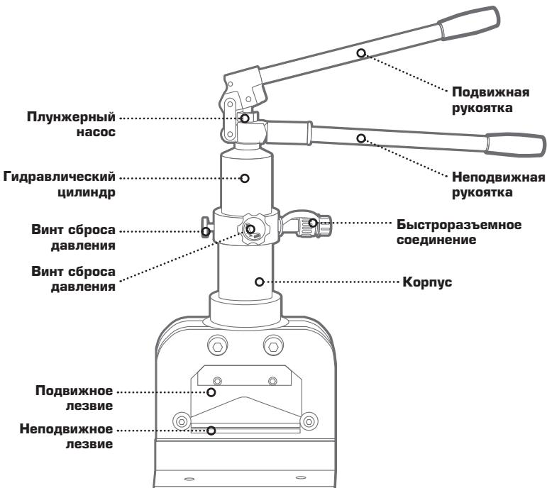
Пресс гидравлический автономный **ШГ-150А (КВТ)** состоит из корпуса и гидравлического цилиндра. В гидравлическом цилиндре объединены гидравлический насос и непосредственно исполнительное устройство – гидроцилиндр с поршнем. Сверху гидроцилиндра имеются две рукоятки. Подвижное лезвие крепится на конце штока поршня гидроцилиндра, неподвижное – на корпусе. Снизу корпус имеет отверстия для стационарного крепления инструмента.
