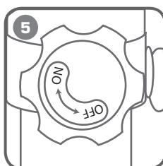
Отключите контур быстрого хода поршня, для чего поверните винт быстрого хода в положение «OFF» примерно на 3/4 оборота. При отключении контура быстрого хода усилие на рукоятках заметно снизится.
