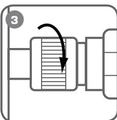
Подключите внешний гидравлический насос (помпу) при помощи рукава высокого давления через быстроразъемное соединение. Плотно затяните гайку.
