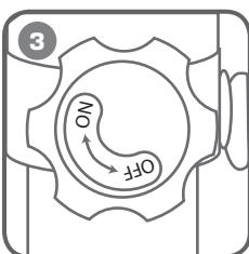
Подготовьте контур быстрого хода поршня, для чего поверните винт быстрого хода в положение «ON» до упора.
