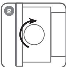
Приведите гидравлическую схему в рабочее состояние для чего поверните винт сброса давления до упора по часовой стрелке в положение «Закрыто»
