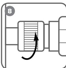
После завершения работы убедитесь, что давление в системе помпыброшено. Открутите гайку быстроразъемного соединения и отсоедините рукав высокого давления.
