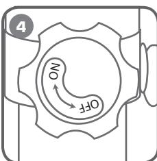
Отключите контур быстрого хода поршня, для чего поверните винт быстрого хода в положение «OFF».
