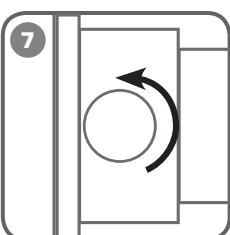
Сбросьте давление в системе повернув винт сброса давления против часовой стрелки на 3/4 оборота в положение «Открыто».
