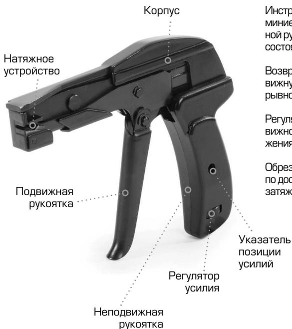
Инструмент TG-01 состоит из легкого алюминиевого корпуса, подвижной и неподвижной рукоятки, натяжного устройства с пазом, состоящего из зубчатой собачки
