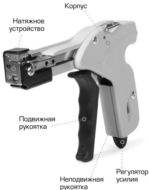
Инструмент TG-05 состоит из литого стального корпуса, подвижной и неподвижной рукоятки, натяжного устройства с пазом, состоящего из зубчатой собачки, механизма и пружин
