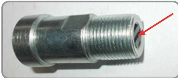
10. Точно также, надавив на шарик в «папе» установленном на шланге РВД, нужно проверить его настройку. Ход шарика также должен составлять 3,5-4 мм.
