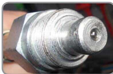
3. Для того чтобы сбросить давление в инструменте, необходимо надавить на штырек. Сделать это можно выколоткой или любым другим подходящим инструментом. Так как давление в инструменте высокое, продавить усилием руки штырек не получится. Для сброса давления необходимо несильно ударить по выколотке молотком. Силу удара подберите опытным путем: если давление не сбросилось, ударьте сильнее. Так как из БРС брызнет масло, не забудьте обернуть его ветошью.
