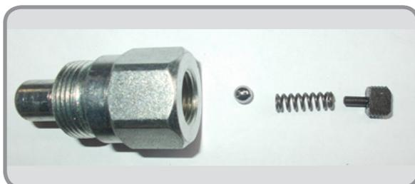
13. Настройка запирающего клапана «папы» производится так же, как и настройка отпирающего клапана «мама». Необходимо закрутить регулировочный винт до упора и открутить его на 3,5-4 оборота.
