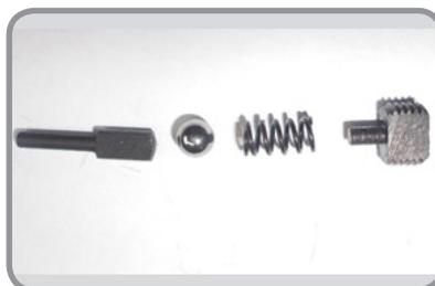
9. Для регулировки закрутите регулировочный винт до упора. Затем открутите его на 3,5-4 оборота. Это обеспечит ход штырька и, соответственно, шарика клапана, на 3,5-4 мм. Для облегчения регулировки конструкция выполнена таким образом, что, при правильной настройке, торец винта будет совпадать с торцом корпуса БРС.
