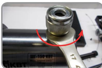
7. Выкрутив «маму» из инструмента, на обратной стороне можно увидеть регулировочный винт, который и регулирует величину хода штырька:
