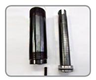
7. Внутри штока установлена возвратная пружина. Пружина закреплена имбусовым болтом М6. Возьмите шестигранник, вставьте его внутрь пружины, выкрутите крепежный болт и выньте пружину.
