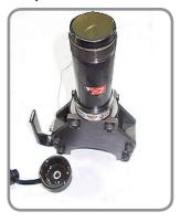
Положите инструмент и открутите против часовой стрелки гидроцилиндр вместе с установленным в нем штоком.
