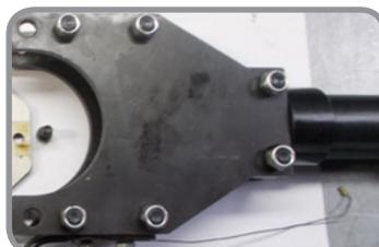
3. Установите ножницы вертикально и открутите против часовой стрелки заднюю крышку вместе с установленной в ней БРС. Будьте аккуратны, в задней части имеются остатки масла. Слейте эти остатки во избежание попадания масла на одежду.
