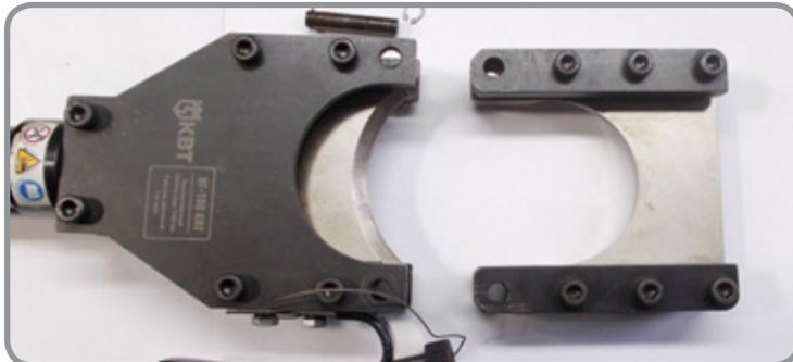
2. Подсоедините к инструменту гидравлическую помпу. Аккуратно нагнетайте давление в инструменте, пока шток не выдвинется настолько, что покажется винт крепления подвижного лезвия. Выкрутите винт, выньте подвижное лезвие. Затем сбросьте давление, чтобы шток вернулся в исходное положение. Отсоедините помпу от инструмента.
