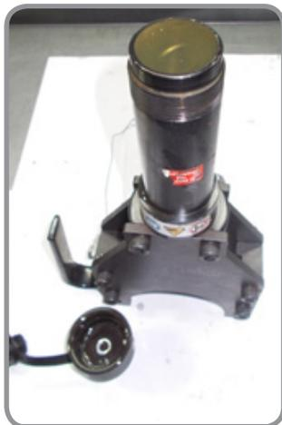
4. Положите инструмент и открутите против часовой стрелки гидроцилиндр вместе с установленным в нем штоком.
