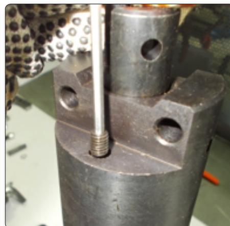
6. Открутите нижнюю часть крепления планок против часовой стрелки и выньте пружину. Теперь шток доступен для замены уплотнительных колец. Замена колец производится аналогично как для прессы ПГР-300 (см. п.2. ремонт ПГР-300).
