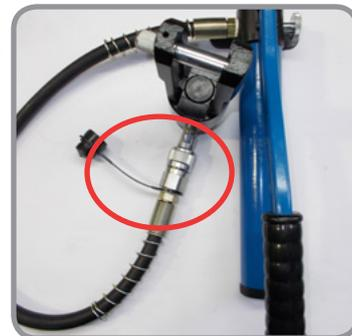
2. Очень важно, чтобы после очередного соединения БРС гайка была закручена до упора, как показано на фото. В противном случае клапан, установленный внутри БРС, не откроется до конца и будет срабатывать только в одну сторону, а именно на нагнетание давления, обратно сбрасывать давление БРС уже не даст. Открыв дроссельный винт на помпе, Вы сбросите давление только в РВД, в самом же инструменте давление останется.
