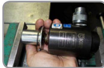
5. Снимите стопорное кольцо, стакан и возвратную пружину.
