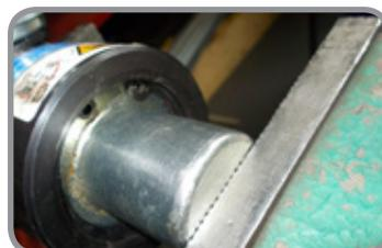
4. Возьмите кольцо-съемник для внутренних колец и снимите стопорное кольцо на задней части пресса. Медленно разведите губки тисков до полного ослабления возвратной пружины, придерживайте пресс и детали от падения.
