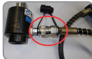
2. Очень важно чтобы после очередного соединения БРС гайка была закручена до упора, как показано на фото. В противном случае клапан, установленный внутри БРС, не откроется до конца и будет срабатывать только в одну сторону, а именно на нагнетание давления, обратно сбрасывать давление БРС уже не даст. Открыв дроссельный винт на помпе, Вы сбросите давление только в РВД, в самом же инструменте давление останется.
