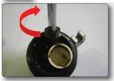
Залейте масло в емкость и установите назад неподвижную рукоятку, закрутив ее до упора по часовой стрелке. Опробуйте пресс на холостом ходу с установленными в него матрицами.
