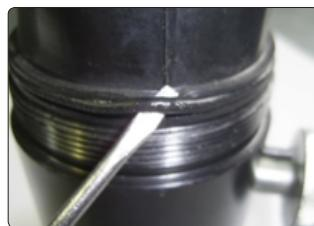
Выкрутите регулировочный винт против часовой стрелки на один оборот (360°). Для того, чтобы пресс создавал большее давление, надо взять шлицевую отвертку или шестигранник, в зависимости от того, какой регулировочный винт установлен в АСД, и повернуть регулировочный винт по часовой стрелке.
