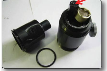
Поворот винта против часовой стрелки, наоборот, будет ослаблять создаваемое давление.
