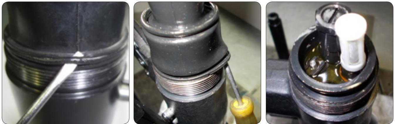
5. Для того чтобы пресс создавал большее давление, надо взять шлицевую отвертку, и повернуть регулировочный винт клапана АСД по часовой стрелке. Делать это следует аккуратно, т.к. даже поворот винта на 90° увеличивает усилие ориентировочно на 10 Мпа. Поэтому увеличивать давление следует постепенно, поворачивая винт каждый раз не более чем на 30°.
