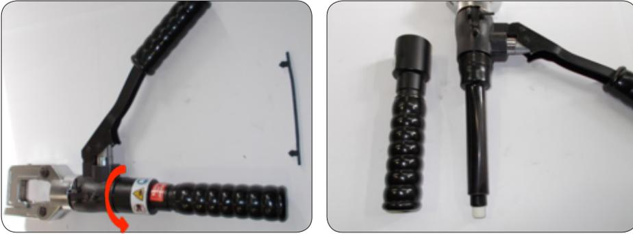
Внутри корпуса неподвижной рукоятки находится резиновая емкость, заполненная гидравлическим маслом. Это масло необходимо слить, во избежание его попадания на одежду в процессе ремонта.
