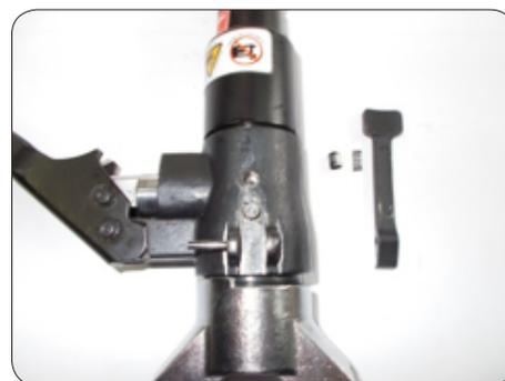
3. Снимите пластмассовый фиксатор рукояток и открутите неподвижную рукоятку.
