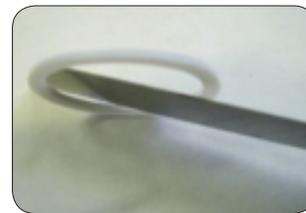
После того как Вы разрежали фторопластовое кольцо, установите на шток сначала резиновое кольцо, а затем – разрезанное фторопластовое. Будьте внимательны при установке колец, они должны быть установлены именно в той последовательности, как показано на фото. В противном случае после первой же опрессовки кольца придется снова менять местами.
