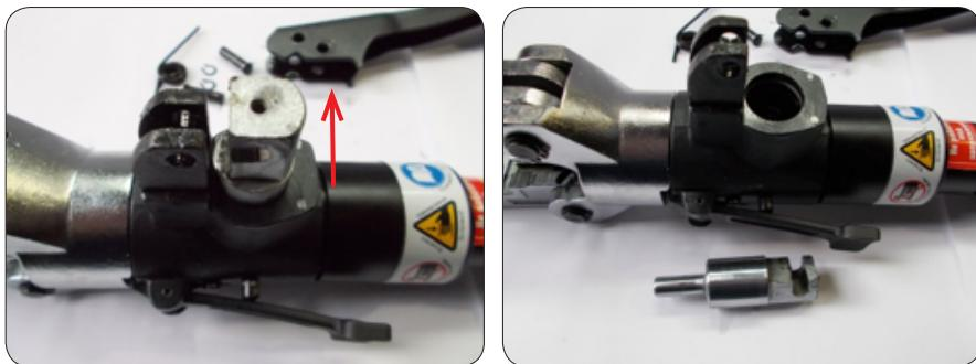
Внимательно осмотрите поверхность плунжера и внутреннюю поверхность цилиндра плунженра, на наличие задиров, рисок и глубоких царапин. Если таковые имеются, потребуется замена самого плунжера или же корпуса. Замена колец в этом случае вряд ли поможет исправить ситуацию.
