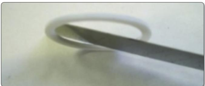
После того как Вы разрезали фторопластовое кольцо, установите в паз штока сначала резиновое кольцо, а затем разрезанное фторопластовое. Будьте внимательны при установке колец, они должны быть установлены именно в той последовательности, как показано на фото. В противном случае, после первой же опрессовки, кольца придется снова менять местами.
