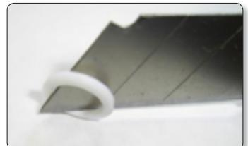
При помощи ранее изготовленных крючков, установите резиновое кольцо в нижний паз узкого канала, а за ним в тот же паз установите фторопластовое кольцо. Резиновое кольцо должно быть ниже фторопластового.
