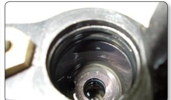
Затем установите два резиновых кольца одинакового диаметра в верхние пазы широкой части рабочей полости плунжера.
