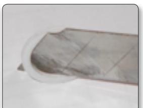
При помощи ранее изготовленных крючков, установите резиновое кольцо меньшего диаметра в нижний паз, а за ним в тот же паз установите фторопластовое кольцо. Резиновое кольцо должно быть ниже фторопластового.
